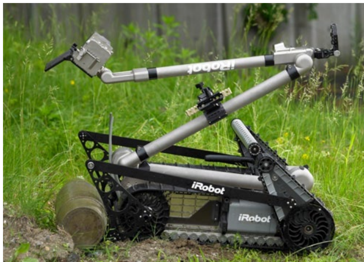
Рисунок 1.7 – Схема реконфигурируемой колесно-гусеничной платформы
