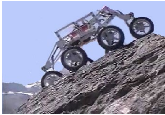
Рисунок 1.2 – Робот Shrimp с пассивной адаптивной подвеской
